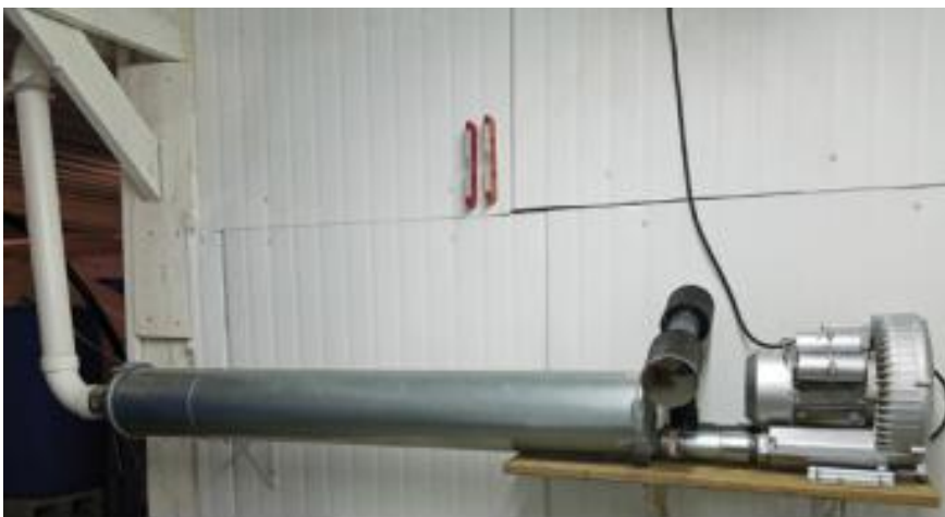
Figura 1. Un soplador regenerativo con un tubo de enfriamiento. Dos filtros de aire evitan que entren residuos en el soplador y deben ser examinados con regularidad y limpiarlos si es necesario.
