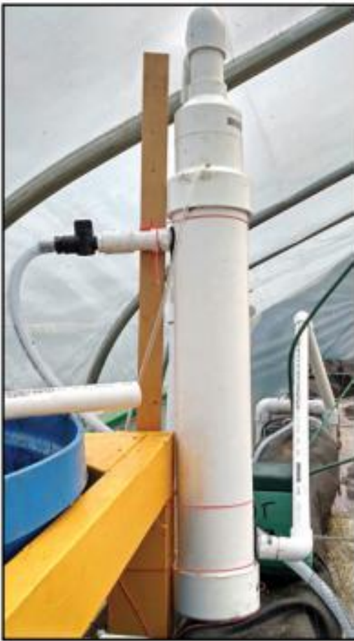
Figura 3. Fraccionador de espuma casero. Una válvula cerca de la entrada se utiliza para ajustar el flujo. Una bomba sumergible manda agua a este filtro.
