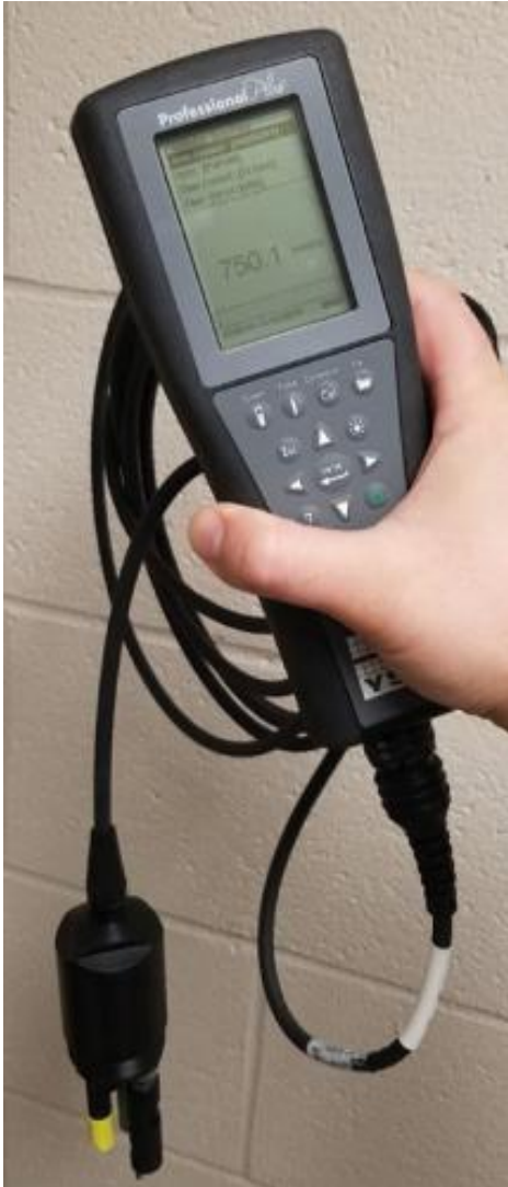
Figura 9. Instrumento de medición de parámetros. Esta unidad mide temperatura, pH, OD, salinidad, conductividad y presión barométrica. Este tipo de dispositivo es costoso, sin embargo, es fácil de usar y genera rápidamente valores de los parámetros más críticos en producción.
