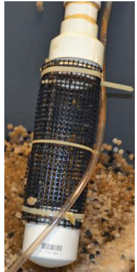
Figura 6. Malla de salida en un biofiltro, el marco es de alambre recubierto de PVC para darle la forma cilíndrica. Esta se puede colocar en el fondo del tanque para permitir que el agua pase más no el material filtrante. Se puede notar el material de filtrado que en su mayor parte se ha vuelto marrón, indicando que una población de bacterias útiles se ha establecido.
