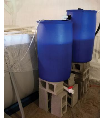
Figura 5. Sedimentador simple y biofiltro. El sedimentador está más alto para permitir que el agua pase al biofiltro por gravedad. Los filtros se apoyan en bloques de hormigón. Note las superficies protegidas en el recinto y el tanque cubierto.
