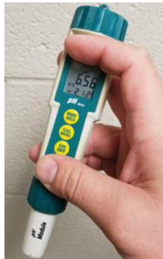
Figura 10. Medidor de pH y temperatura. Equipo de mucho menor costo que un instrumento multiparámetro. Equipos similares pueden medir el OD y la salinidad. Es importante seguir las instrucciones del fabricante para calibrar las sondas periódicamente; esto asegura la precisión de los mismos.
