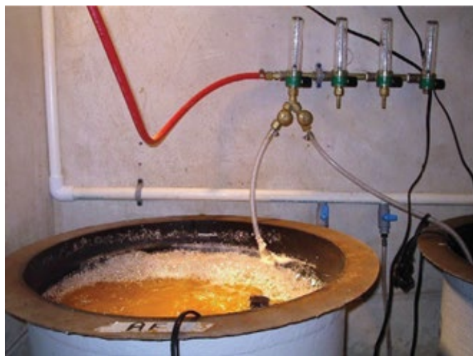
Figura 3. Cono de eclosión de Artemia . Observe los reguladores de inyección de oxígeno puro en la pared y el cable del calentador sumergible en el borde frontal del tanque.
