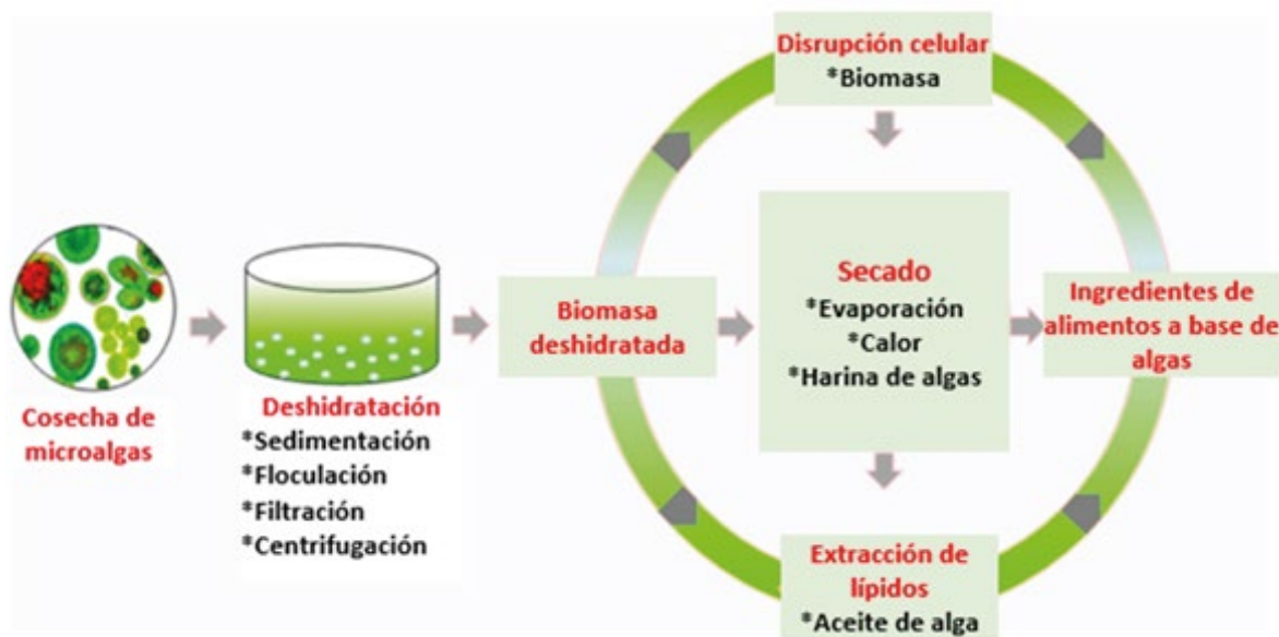
Figura 1. Procesamiento de microalgas para formulación de alimentos acuícolas, entre ellos: secado, biomasa deshidratada y extracción de lípidos para generar aceite.
