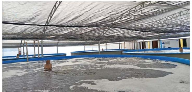
**Figura 2. Pantalla de sombra instalada dentro del invernadero, arriba de los tanques de precría.**
