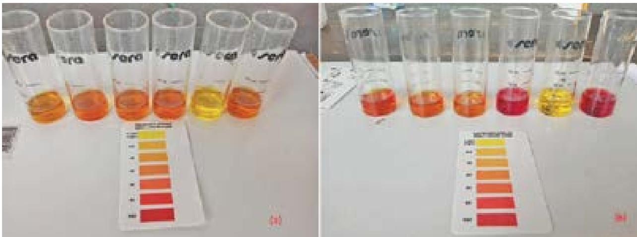
**Figura 6. Prueba de nitrato realizada en el agua de los precriaderos de tres (a) y 14 (b) días de cultivo, después de la implementación de actualizaciones estructurales y gestión sugerida, demostrando el ciclo de amoníaco y nitrito.**
