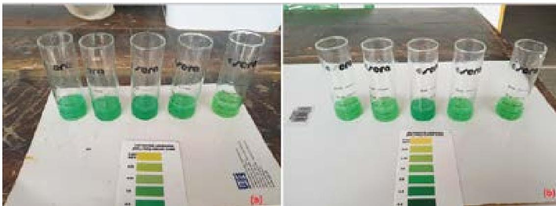
**Figura 4. Prueba de amonio realizada en el agua de los precriaderos de tres (a) y 14 (b) días de cultivo, antes de la implementación de actualizaciones estructurales y de manejo sugerido.**
