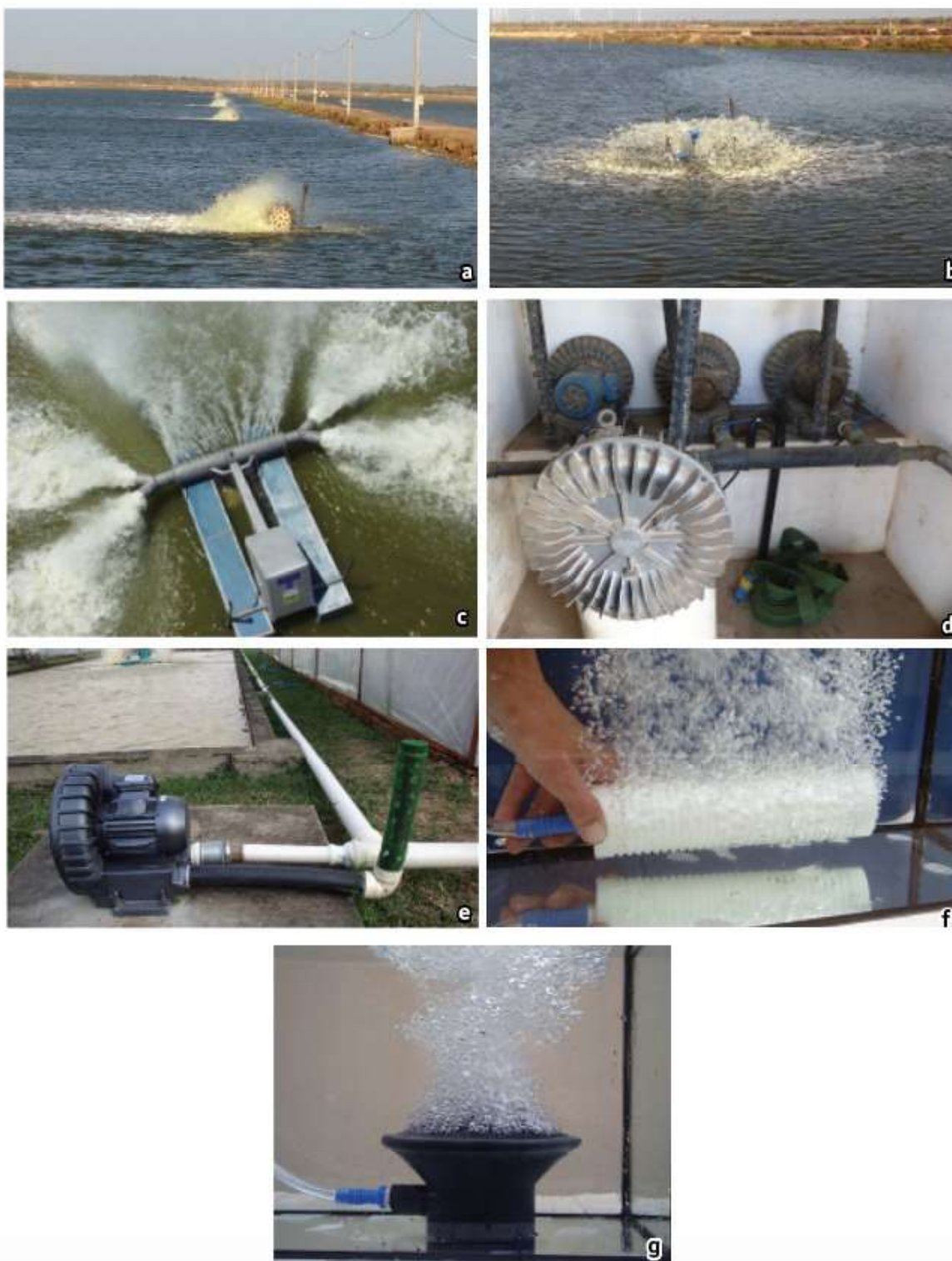
Figura 3. Imágenes de diferentes tipos de aireadores y sistemas de aireación utilizados en estanques y tanques de peces y camarones. a) aireador de paleta; b) aireador de fuente (bomba vertical); c) bomba de agua adaptada como aireador. Imágenes de sistemas de aireación de aire difuso: d y e) sopladores radiales; f y g) difusores de aire (sistema utilizado generalmente en tanques pequeños en cultivos intensivos).
