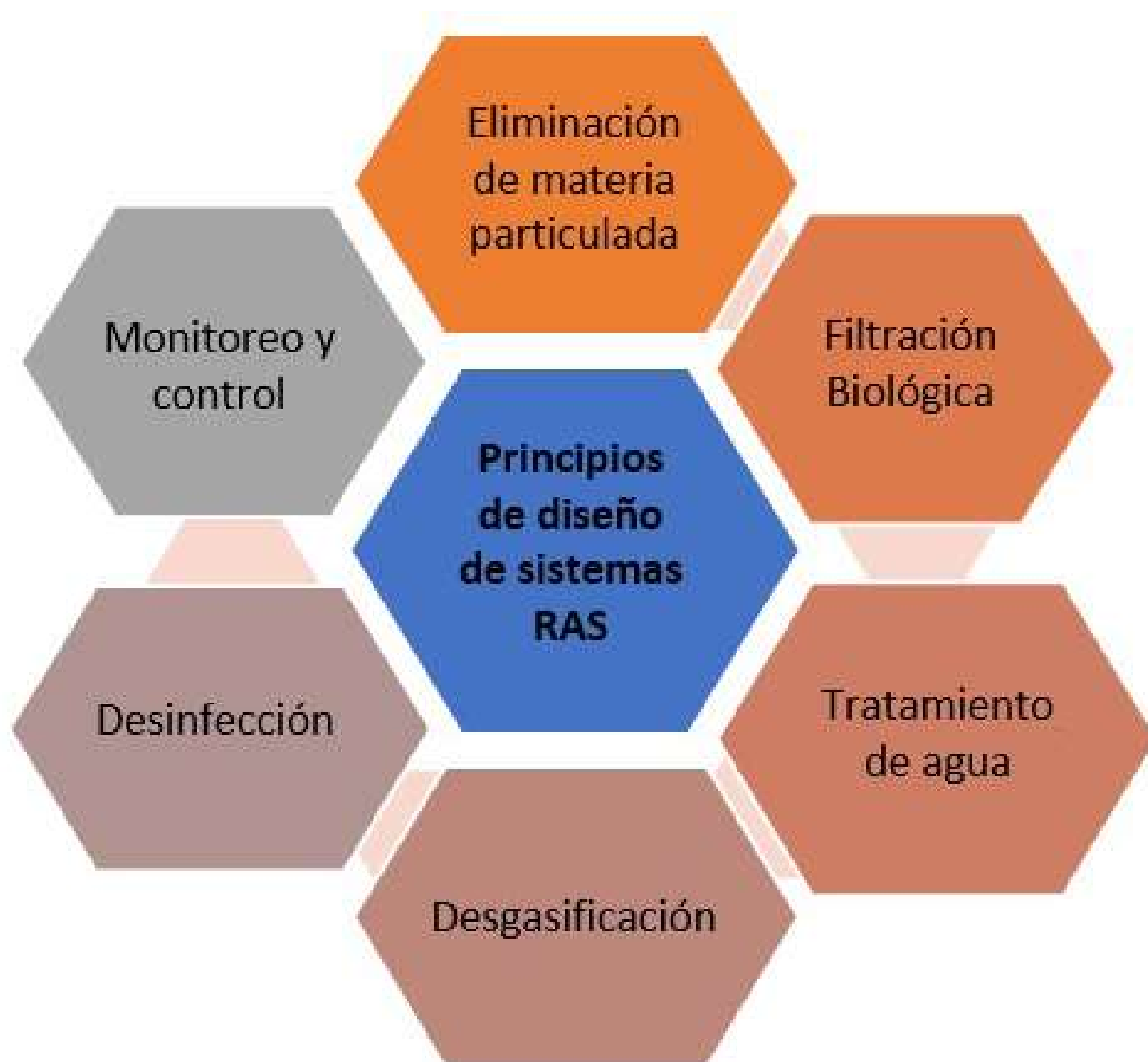
Figura 2. Principios básicos del diseño RAS en acuicultura.
