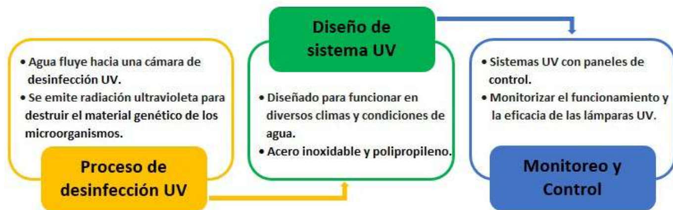
Figura 1. El proceso de desinfección por radiación ultravioleta se utiliza para el tratamiento y la filtración del agua.
